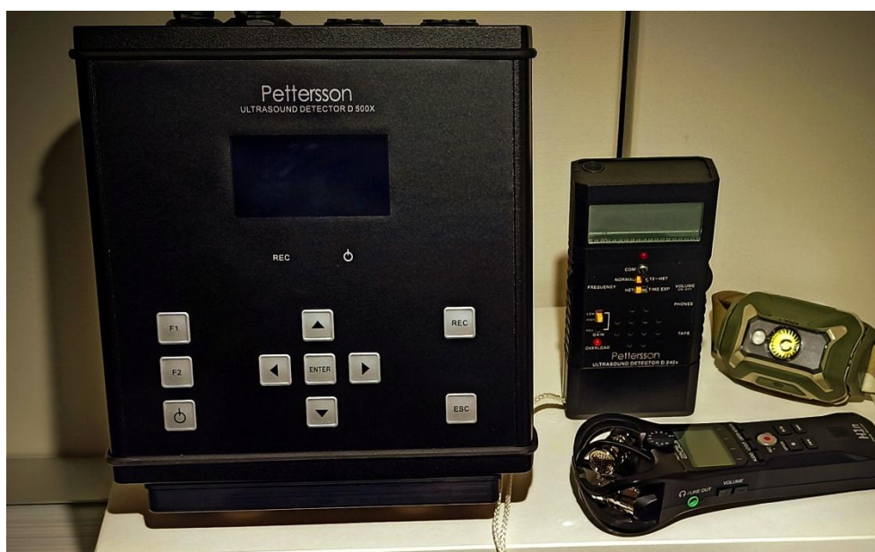
Foto 11 - Attrezzatura utilizzata per il monitoraggio dei chiroterri. Da destra verso sinistra: Rilevatore a eterodina ed espansione temporale (x10 e x20 selezionabile). Bat detector D 500X per la registrazione prolungata in campo degli ultrasuoni. Registratore multitraccia collegato al D 240X.
