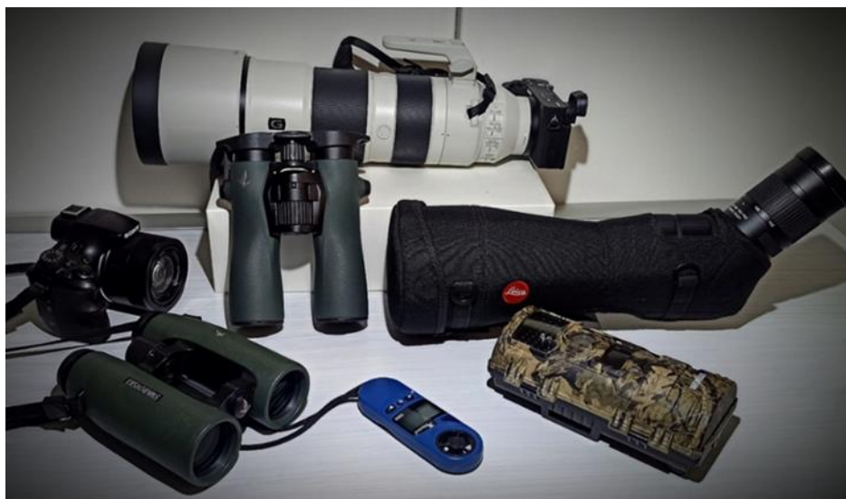
Foto 3 - Attrezzatura utilizzata per lo studio dell'Avifauna. Binocolo Swarovsky EL 10X42 – NL PURE 10X42 e cannocchiale terrestre Leica APO Televid 82; per la misurazione dell'intensità del vento: Anemometro Kestrel 1000; GPS Garmin E TREX 100; Fotocamere Sony Alpha 1 + tele 200/600 FE e Sony compatta. Fototrappola Wimius.
